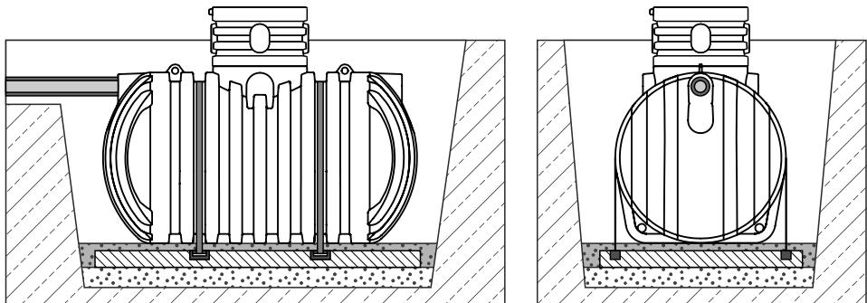
*При залегании подводящего трубопровода на глубине до 1200 мм, необходимо дополнительного утеплить трубопровод!*
