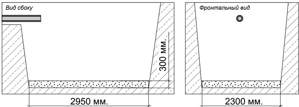
**Рисунок 2.2. Схема дренажа**
